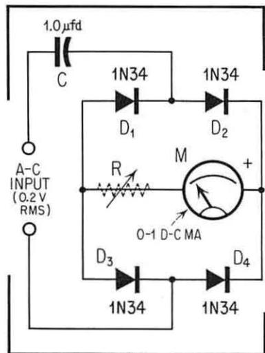
Fig. 6. Full-Wave Meter Rectifier Circuit.
