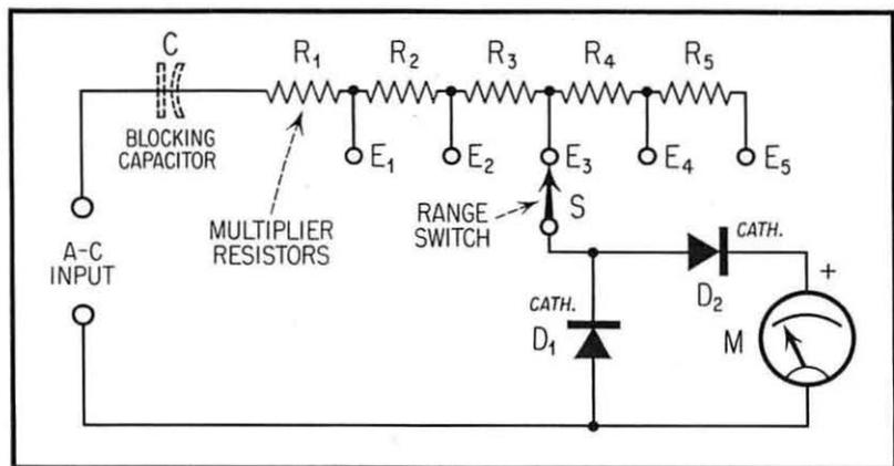
Fig. 5. Multi-Range Voltmeter.
