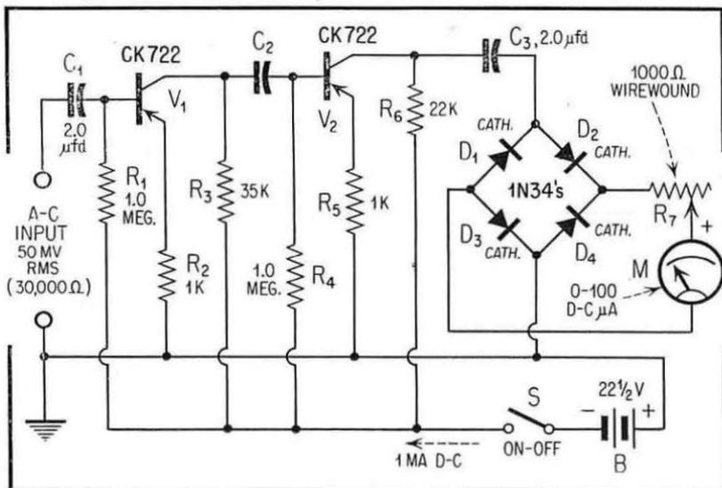
Fig. 8. Two-Stage Transistor-Diode Voltmeter.
