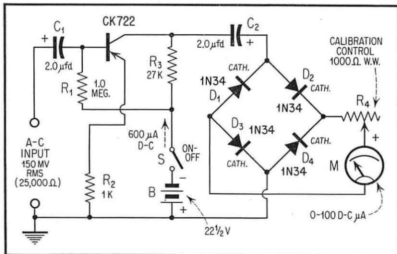
Fig. 7. Single-Stage Transistor-Diode Meter.
